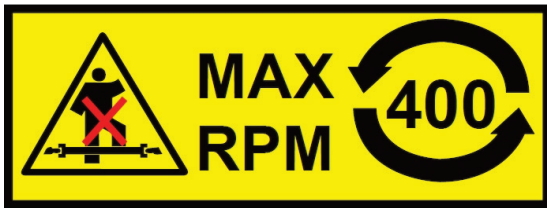
¡Cuidado con la toma de fuerza giratoria! Velocidad de rotación máxima permitida y dirección de la toma de fuerza.
